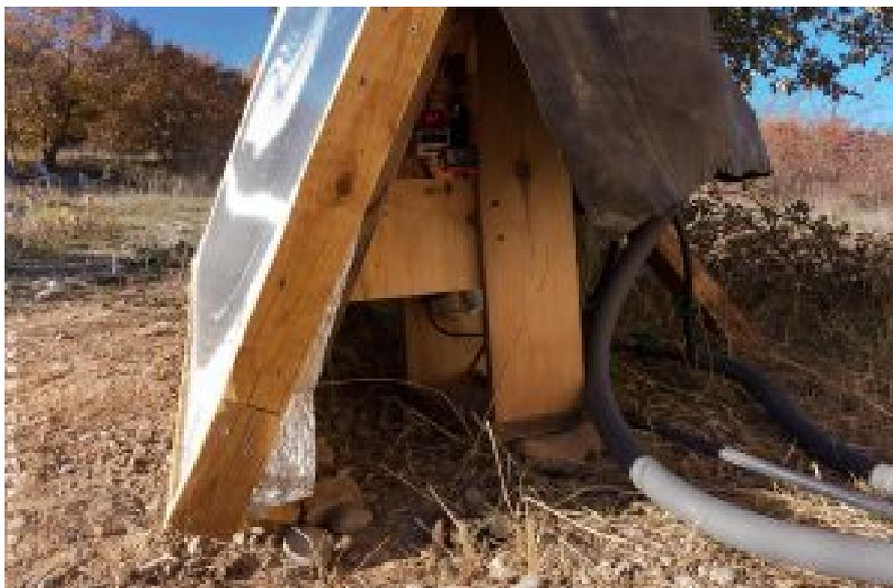
La bomba, el termostato y los termómetros están instalados en la parte de atrás del panel solar. Los tubos están aislados con manguitos de goma. El frontal del panel está cubierto con una lámina de metacrilato.
